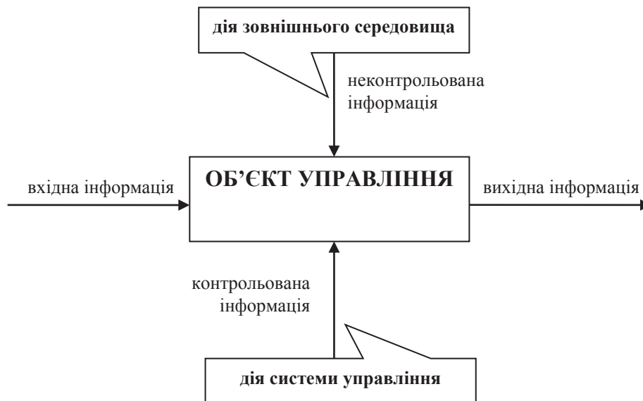
Рис. 1. Схема управління об'єктом з урахування параметрів системи
