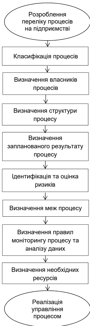
Рис. 1. Алгоритм упровадження процесного підходу на підприємствах взуттєвого виробництва
